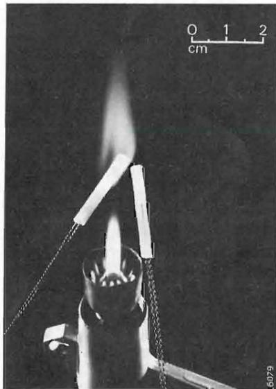
Può essere impiegato in forni industriali, in sistemi di riscaldamento a gas o con combustibili liquidi per controllo fiamma, nella misura dei gas di scarico di qualsiasi tipo; nei jet per esempio.
