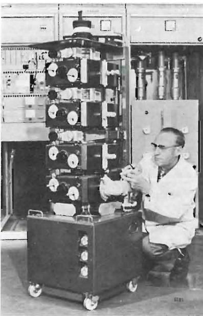
**NUOVO SISTEMA DI POSIZIONAMENTO** — Un nuovo sistema di posizionamento orizzontale è stato realizzato dalla Motorola di Scottsdale nell'Arizona. Denominato «Mini Ranger III», il nuovo sistema permette ad un mezzo mobile (natante, elicottero, aereo, veicolo terrestre) di conoscere con precisione la propria posizione rispetto a 2, 3 o 4 punti di riferimento a terra (trasponditori) situati su punti geografici conosciuti.
