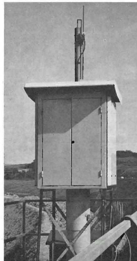
Fig. 10. — Armadio contenitore di apparecchiature radio per misurazione di livello d'acqua di un torrente.
