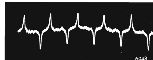
Fig. 5. — Forma d'onda dei segnali di autoallineamento dell'azimut (senza equalizzazione).
