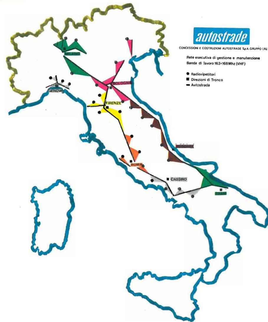
Fig. 1. — Dislocazione dei radioripetitori e loro aree di copertura, delle Direzioni di Tronco della rete radiotelefonica esecutiva di gestione e di manutenzione in banda VHF. La rete della Polizia ha la stessa dislocazione.
