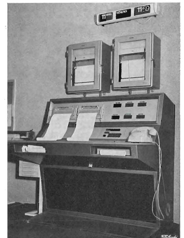
Fig. 11. — Apparecchiatura centrale per la memorizzazione dei dati della rete dei radiopluviometri.
