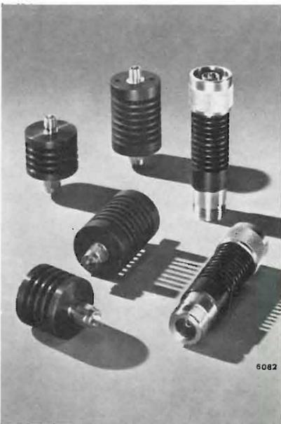
Il modello 303 consente una potenza di entrata fino a 10 W medi e funziona fra 2 e 18 GHz con attenuazioni da 3 a 10 dB con salti di 0,5 dB; usa connettori «SMA».
